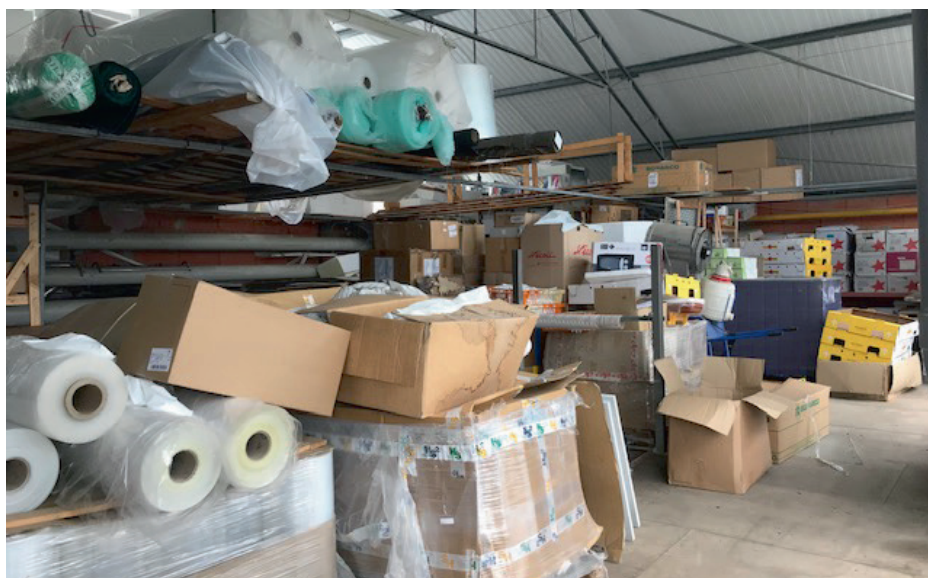
Foto 2: Un magazzino con materiale infiammabile non dovrebbe presentarsi così.
